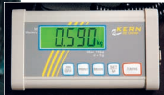
BMW gibt nur Servicegeräte frei, deren Massen- ungenauigkeit bei max. plus/minus 15 Gramm liegt
