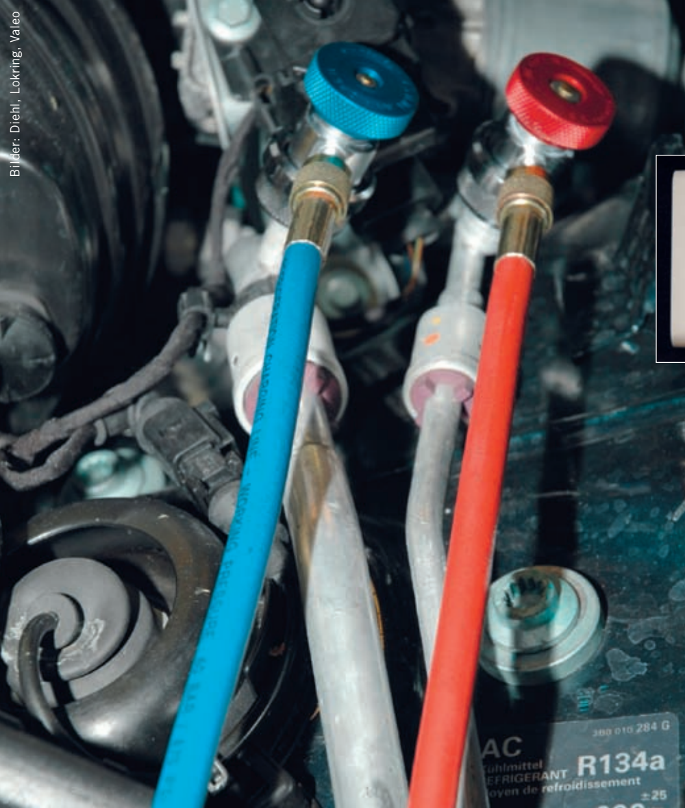
BMW gibt nur Servicegeräte frei, deren Massen- ungenauigkeit bei max. plus/minus 15 Gramm liegt
