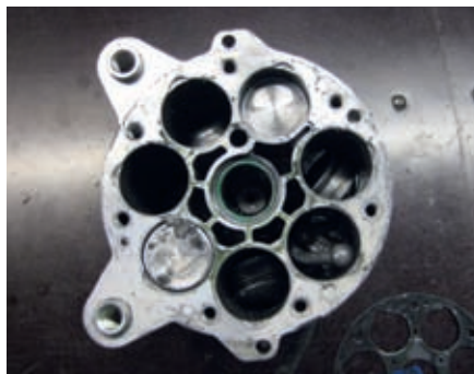
... Fehler bei der Inbetriebnahme neuer Verdichter (zu hohe Anfangsdrehzahl) ...
