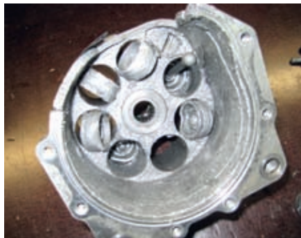
Verdichterschäden sind im Regelfall auf mangelnde Schmierung zurückzuführen, ...
