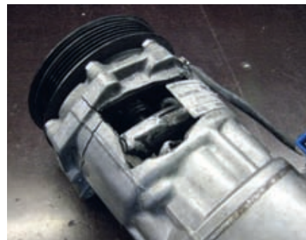
... oder zu geringe Kältemittelmenge in der Anlage, die sich als Temperaturerhöhung auswirkt.
