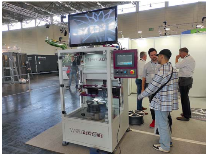
Softwaregesteuerte Aufbereitung von Alu-Felgen von WheelRestore.
