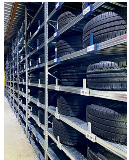
Die liegende Einlagerung im neuen Teil des Räderlagers bringt 40 Prozent mehr Kapazität.
