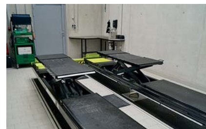
Mit dem Fahrbahn-Radausheber kann das Fahrzeug vollständig entlastet werden.
