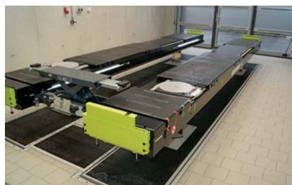
Die Vier-Stempel-Fahrbahn-Hebebühne (fünf Tonnen) von MAHA eignet sich auch zur Lichtmessung.
