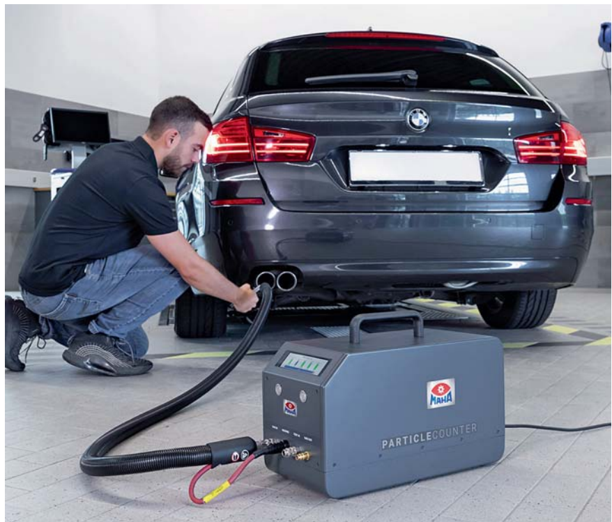
Das Partikelanzahl-Messgerät von MAHA wird sich das DC-Verfahren zunutze machen. Es wurde zusammen mit AVL DiTest entwickelt.
