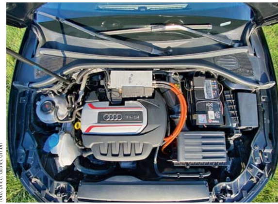
Umgebauter Audi S3 mit GasTronic-Anlage. Der Gastank befindet sich im Kofferraum.
