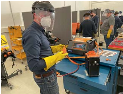
Trainer Tobias Breilmann demonstriert das „Balancing“ eines neuen Batteriemoduls.
