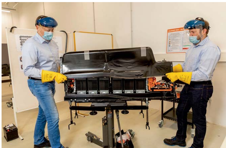
Bei der Demontage einer Traktionsbatterie sind höchste Vorsicht und Sorgfalt geboten.
