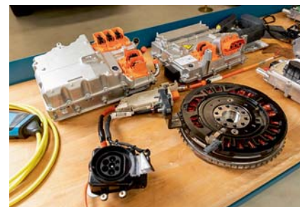
Die Hochvoltkomponenten sind anhand der orangefarbenen Stecker zu erkennen.
