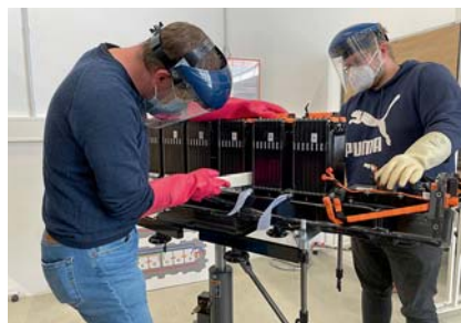
In der Hochvolt-Schulung lernen die Mechatroniker, einzelne Batteriemodule auszubauen.
