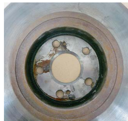
Bei Rissen im Bereich des Bremsscheibentopfes ist dringend eine neue Bremsscheibe fällig.
