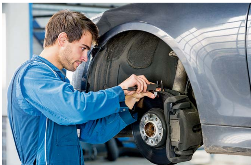
Bremsen-Check: Werkstätten sollten sich bei der Bremszeit für die Inspektion nehmen und beim Austausch von Bremsbelag oder Scheibe gründlich die Komponenten reinigen und entrostern.
