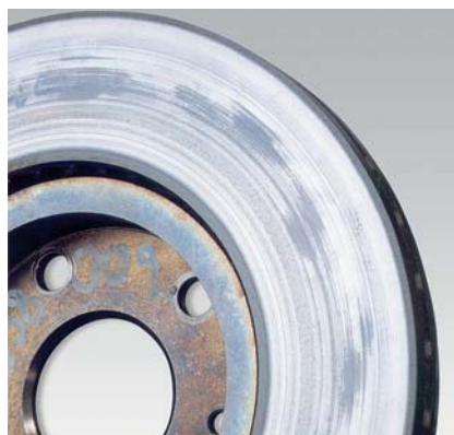
Rubelflecken deuten auf eine Überhitzung der Bremsscheibe hin.
