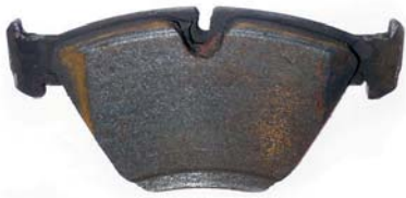
Der Bremsbelag ist korrodiert und zeigt ein fehlerhaftes Tragbild.
