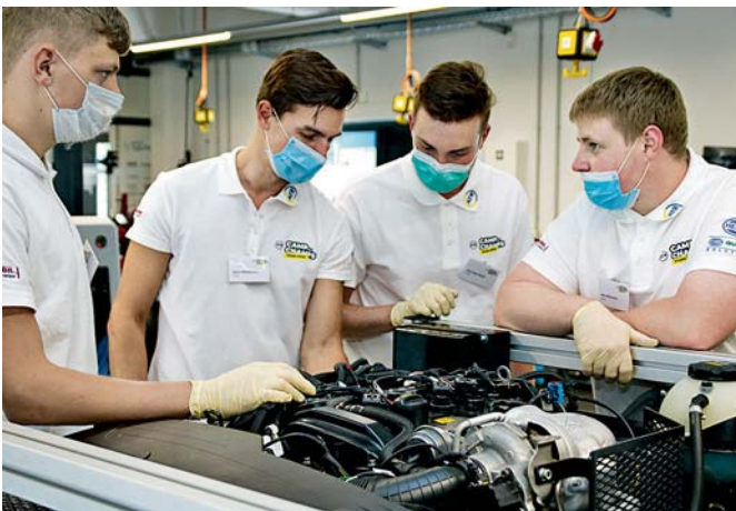
Hier war genaues Hinschauen gefragt: Messung von Sensoren und Aktoren im Motor mittels Diagnosesystem.
