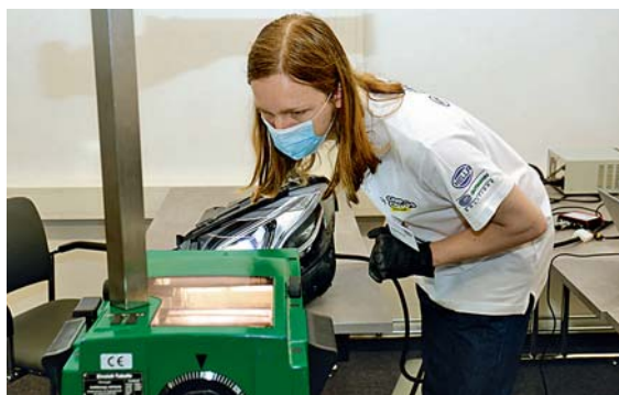
Die praktische Übung mit dem Scheinwerfereinstellprüfgerät war ein Schwerpunkt.
