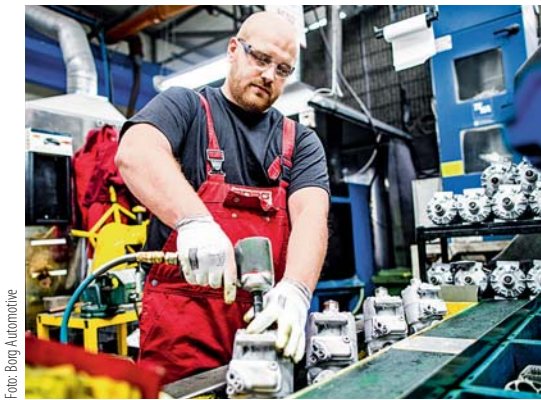
Lichtmaschinen bei der Zerlegung beim dänischen Wiederaufbereiter Borg Automotive.
