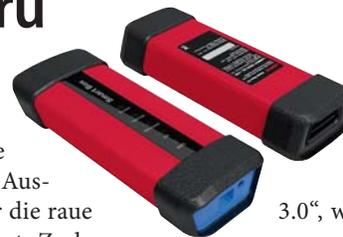
modell von selbst erkannt. Über die dazugehörige Diagnosebox „Smartbox 3.0“, welche mehrere Diagnoseprotokolle einschließlich PassThru J2534 unterstützt, können die Testergebnisse per USB, Bluetooth oder WLAN direkt auf das Diagnose-Tablet übertragen werden. Softwareupdates, der Zugriff auf HaynesPro-Datenbank und Workshop-Data Electronics sind für 24 Monate bereits inkludiert. prz
