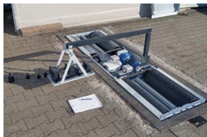
Nach der Fixierung und dem ersten Testlauf wird der Bremsprüfstand kalibriert.
