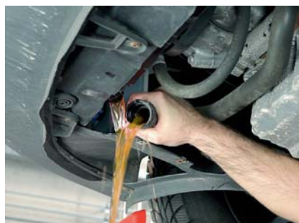
Nachdem der Motor abgekühlt ist, wird als Erstes die alte Kühlflüssigkeit abgelassen.
