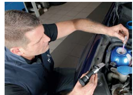
Das Refraktometer gibt Aufschluss darüber, ob das Mischungsverhältnis korrekt ist.
