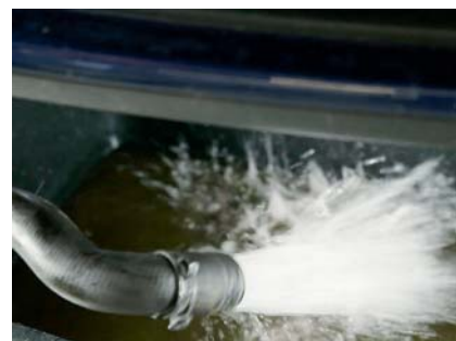
Anschließend folgt die Spülung des Motorblocks und des Kreislaufs zum Wärmetauscher.
