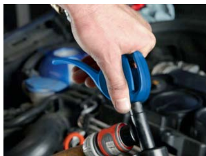
Mit pulsierenden Luftstößen wird nun der Kühler gespült, bis das austretende Wasser klar ist.
