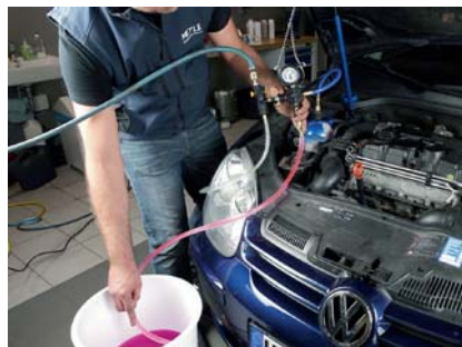
Danach kann das Kühlsystem mit der neuen Kühlflüssigkeit befüllt werden.
