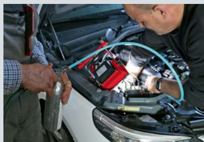
Reiniger und Spülung werden per Druckbecherpistole und Sonde in den Filter gesprüht.
