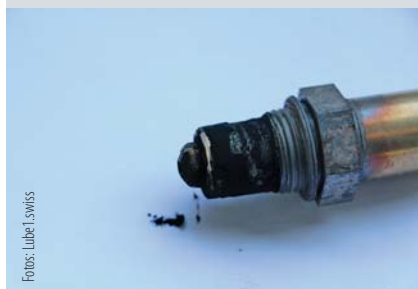
Der herausgeschraubte Sensor macht deutlich, dass sich viel Ruß im System befindet.
