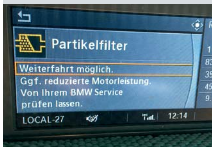
Das Auto (in unserem Fall ein 5er-BWM) weist auf einen verstopften Partikelfilter hin.
