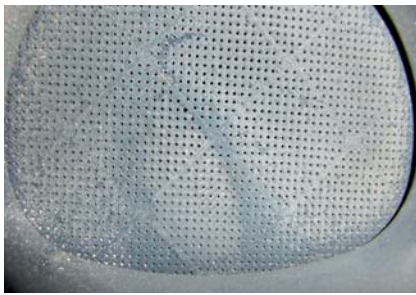
Vor der Reinigung ist der Partikelfilter mit einer dicken Rußschicht belegt.
