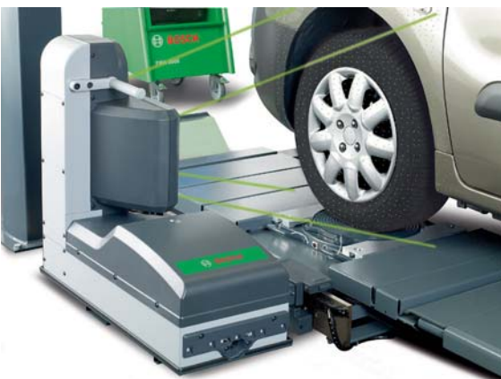
Bosch FWA 9000: Kameras erfassen die Laserpunkte zur Berechnung eines 3D-Radmodells.
