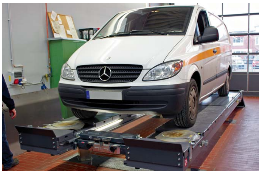
Präziser Arbeitsplatz: Die Vier-Stempel-Hebebühne VS Square II MB mit Achslift von MAHA
